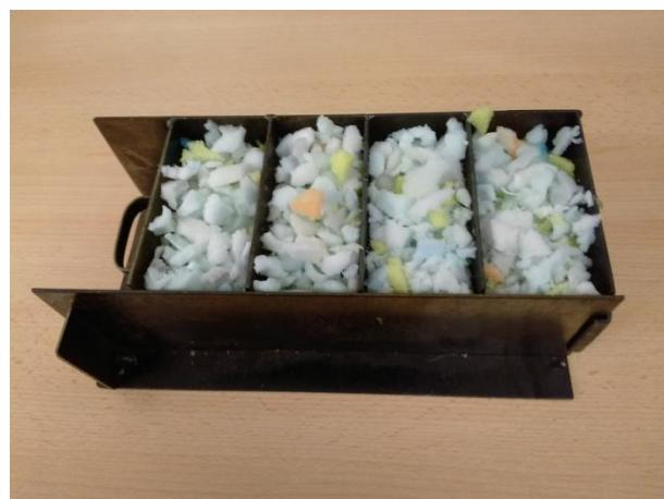
Obrázok 4: Plnenie formy materiálom
