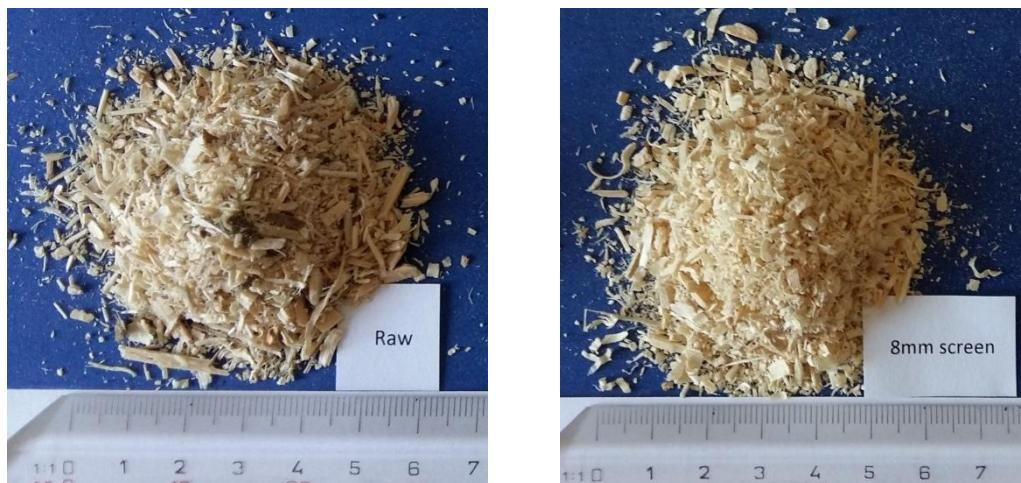
Obrázok 5: Pôvodný nespracovaný materiál (Raw) (vľavo) a materiál dezintegrovaný s použitím sítia s priemerom otvorov 8 mm (vpravo)
