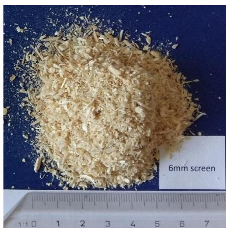
Obrázok 6: Materiál dezintegrovaný s použitím sítia 6 mm
