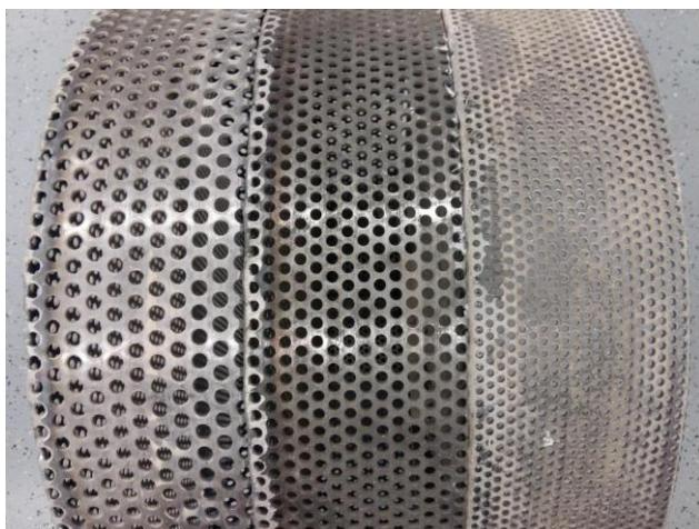
**Obrázok 2: Sítá použité pri spracovaní materiálov (zľava 8mm, 6mm, 4mm)**
