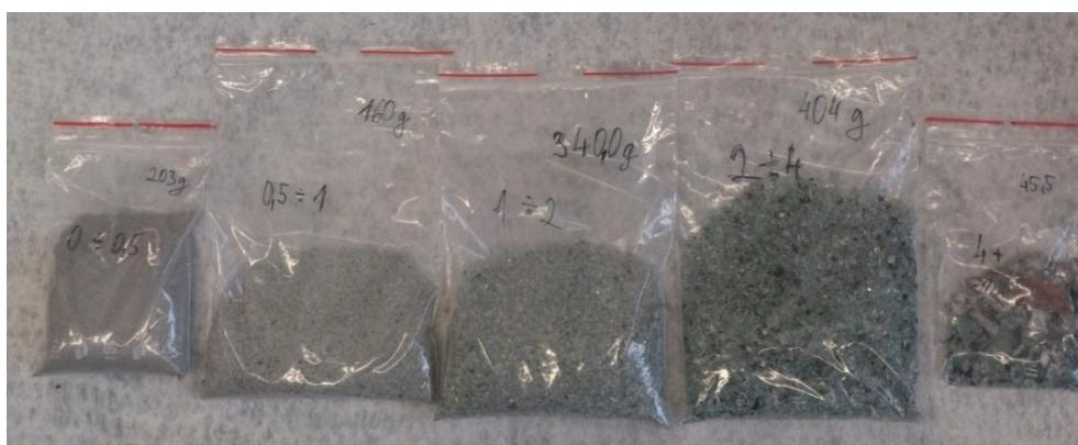
**Obrázok 13: Jednotlivé frakcie skla vzorky 1 po sitovom rozboore**
