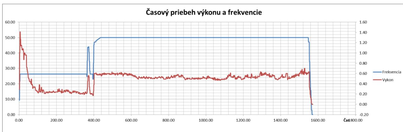
Obrázok 10: Časový priebeh výkonu a frekvencie pohonu dodávaného zariadenia počas skúšobnej prevádzky;  $f$  [Hz],  $P$  [kW]
