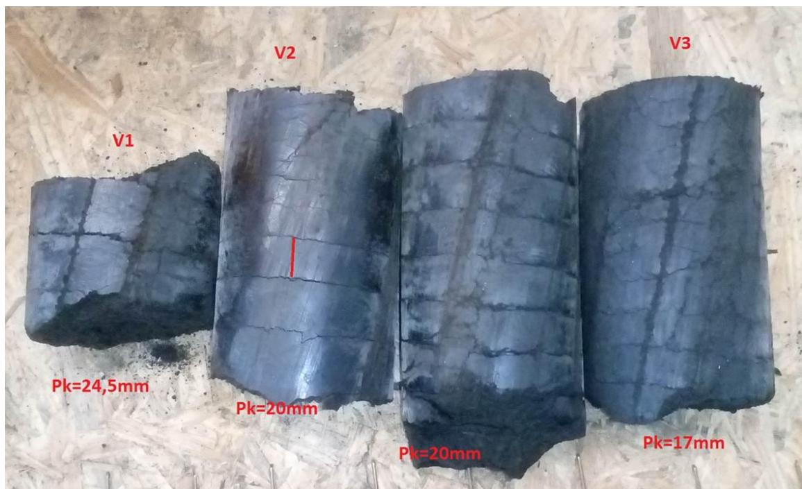
Obrázok 4: Vzorky pri rôznych teplotách. Pk [mm] - stúpanie po kompresii, pôvodné stúpanie závitovky Pz = 80 mm
