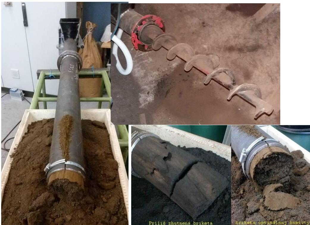
Obrázok 3: Základný skúšobný prototyp zariadenia na STU, kvalita výstupu.
