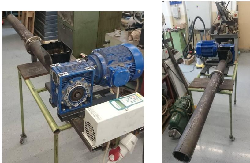
Obrázok 6: Prototyp zariadenia so skúšobným pohonom 2,2 kW; 93 ot/min, prevodovkou  $i=15$  a frekvenčným meničom
