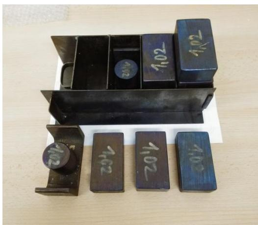
Obrázok 3: Forma a závažia pre výrobu experimentálnych vzoriek
