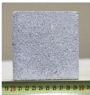
Obrázek 8: Pórová struktura referenčního vzorku v řezu.
