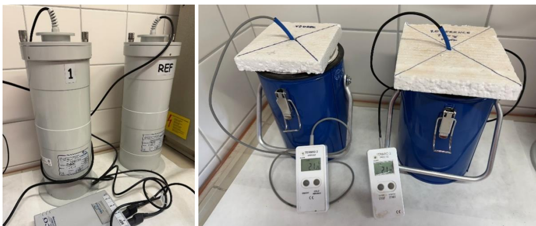
Obrázek 2: Semi-adiabatický kalorimetr (vlevo) dle EN 196-9 a soustava Dewarových nádob pro měření teplot při hydrataci (vpravo)
