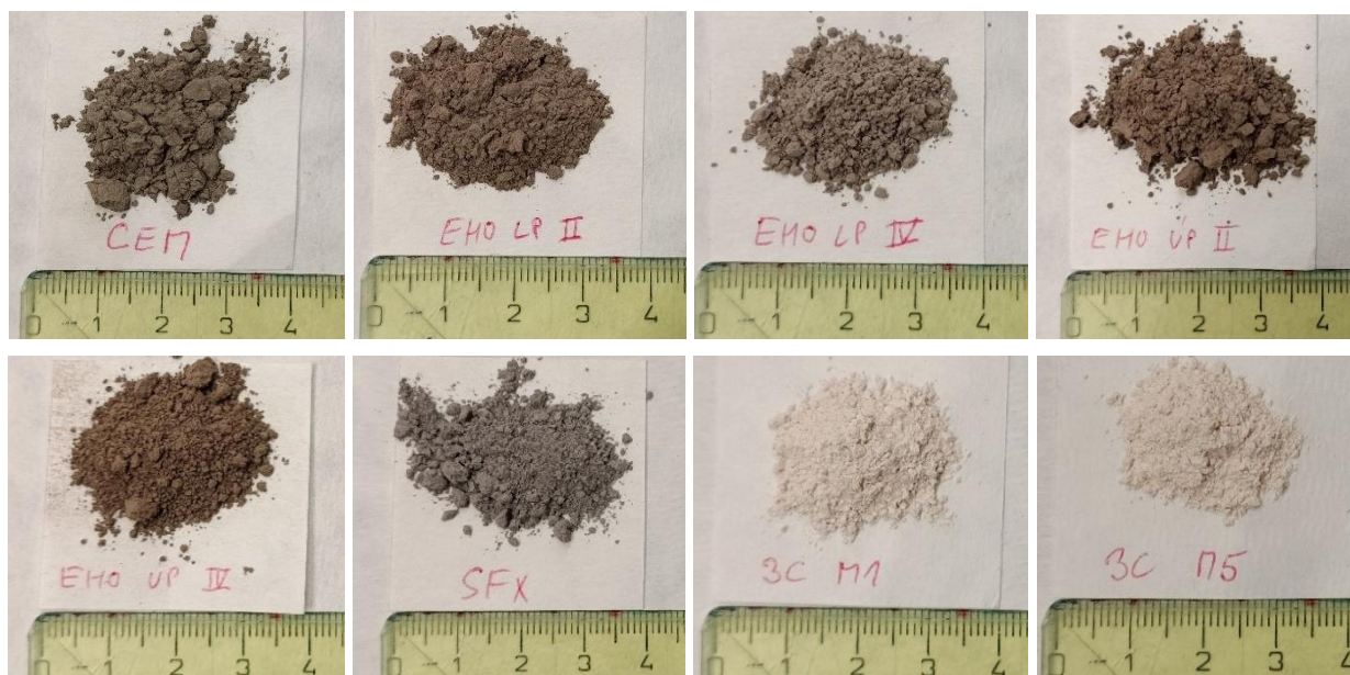
Obrázek 1: Fotografie použitých surovin – zleva nahoře CEM, EHO LP II, EHO LP IV, EHO ÚP II, EHO ÚP IV, SFX, 3C M1, 3C M5
