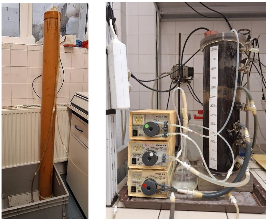
Obrázek 1: Laboratorní stripovací kolona (vlevo); laboratorní nitrifikační reaktor (vpravo)
