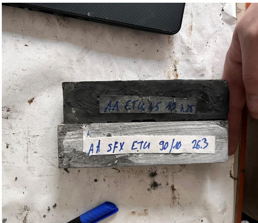
Obrázek 2: Vizuální porovnání délkových změn na zkušebních tělesech
