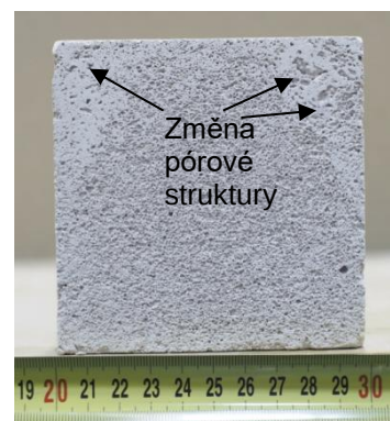
Obrázek 10: Pórová struktura vzorku s mikrocelulózou (v řezu).
