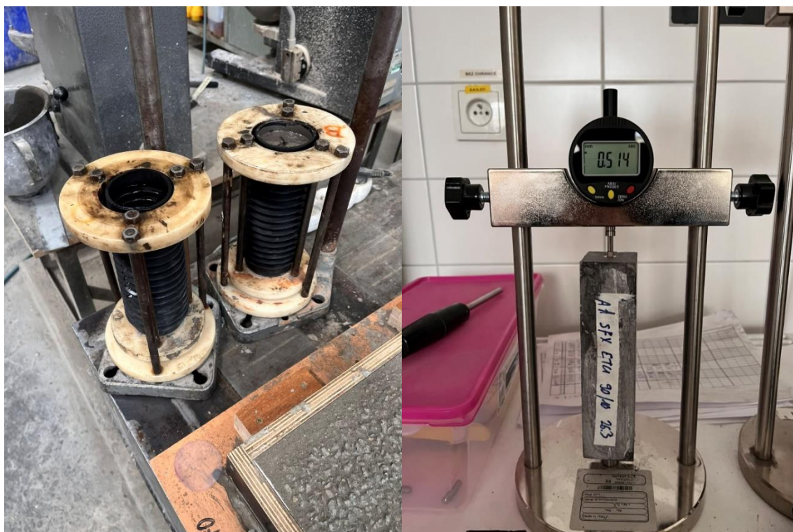
Obrázek 1: Vlnovcová forma se směsí; trámček při měření délkových změn
