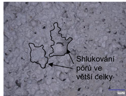
Obrázek 13: Pórová struktura vzorku s mikrocelulózou při zvětšení 20× (v řezu).
