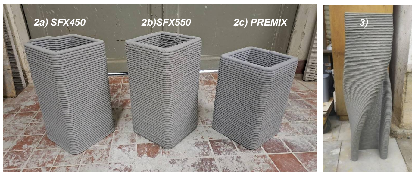
Obrázek 2: Výtisky z posuzovaných směsí: a) SFX450, b) SFX550, c) PREMIX
