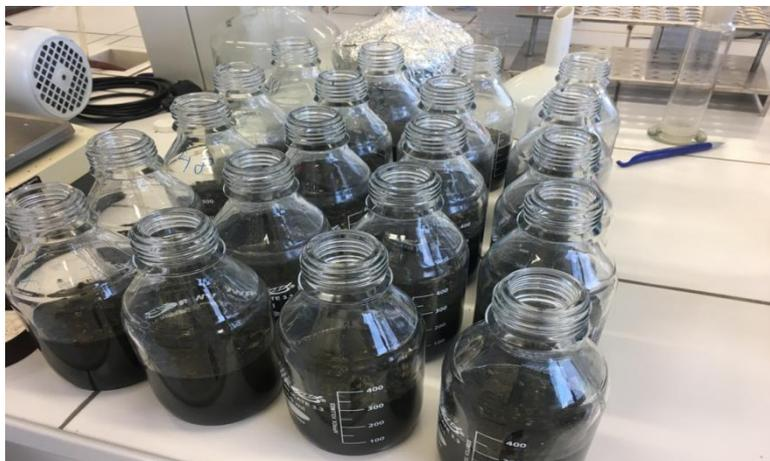
Obrázok 5: vsádzkové anaeróbne reaktory – metanogénne testy
