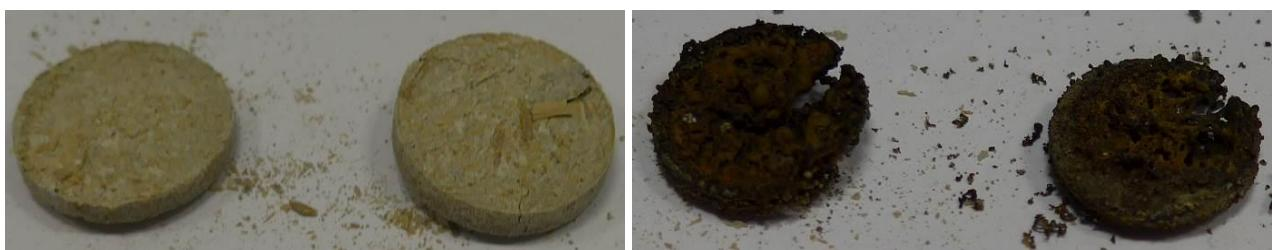
Obrázek 11, 12: Vybrané vzorky před a po provedení kalorimetrické analýzy spalného tepla  $Q_{PCI}$  (prach V4 bez eliminace částic)
