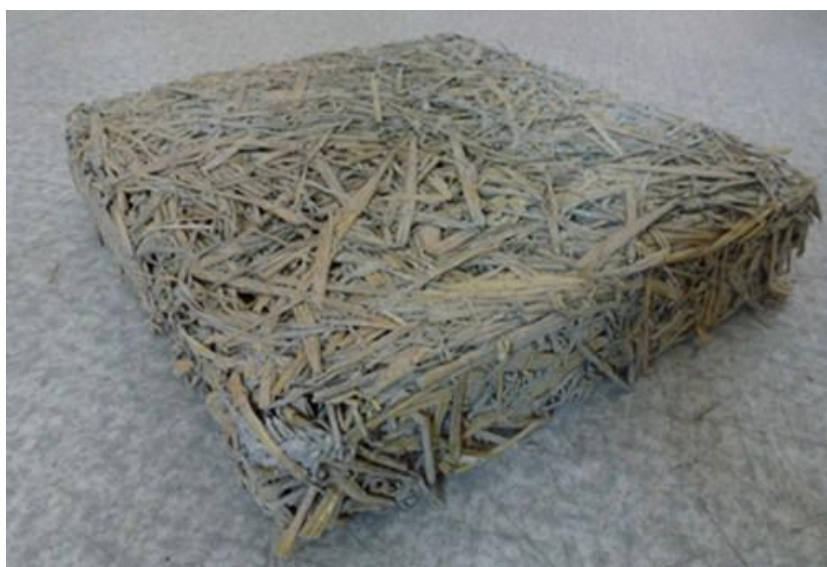
Obrázek 6: Slaměná deska pojená cementovým tmelem rozměrů 300x300x80 mm
