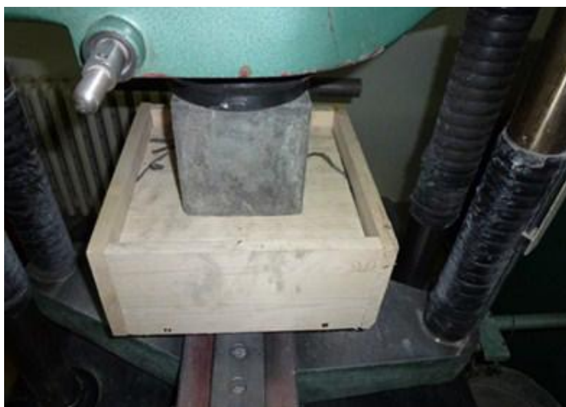
Obrázek 5: Zatěžování silou F = 800 \text{ N} na přítlačnou desku formy
