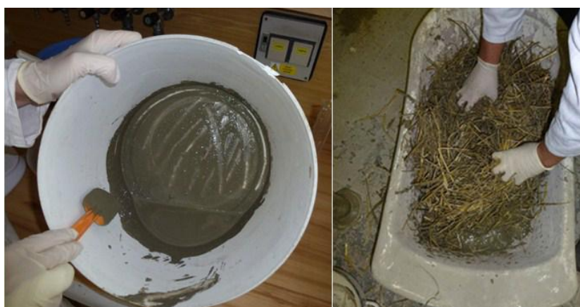
Obrázek 3: Příprava cementového mléka, vylití do plastové vaničky se slámou a následné ruční míchání
