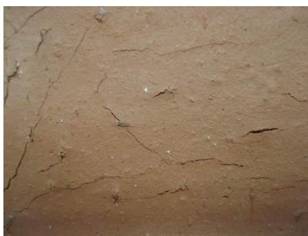
Obrázek 7: Trhliny na povrchu střepu vyrobeného z cihlářské zeminy Jirčany
