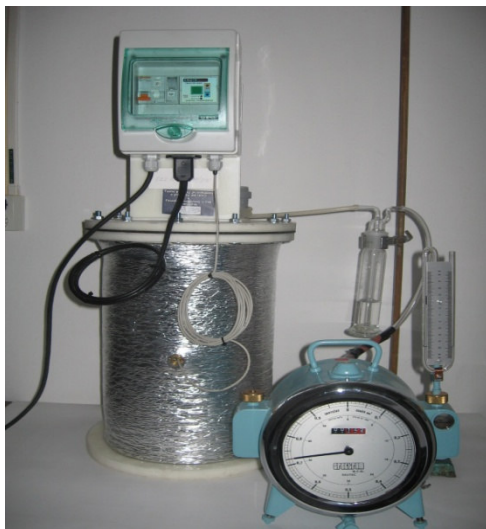
Obrázok 1: Poloprietokový anaeróbny reaktor
