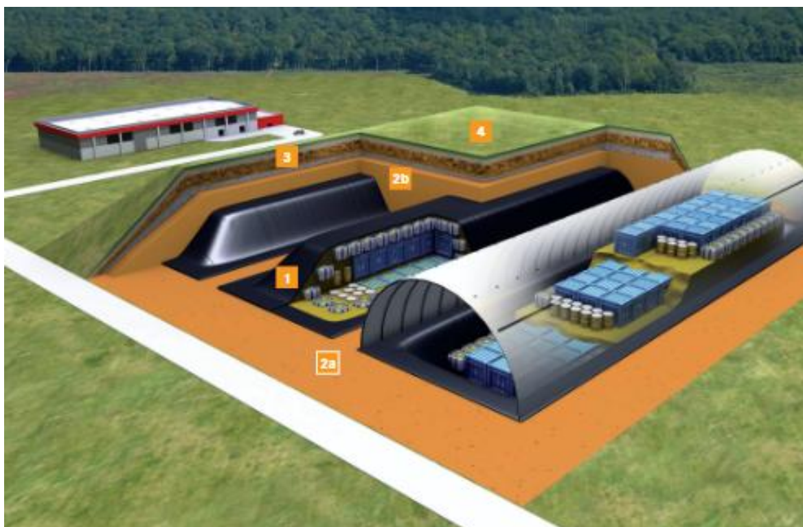
Obrázek 3: Schéma úložiště VNAO CIRES, ANDRA, Francie 19
