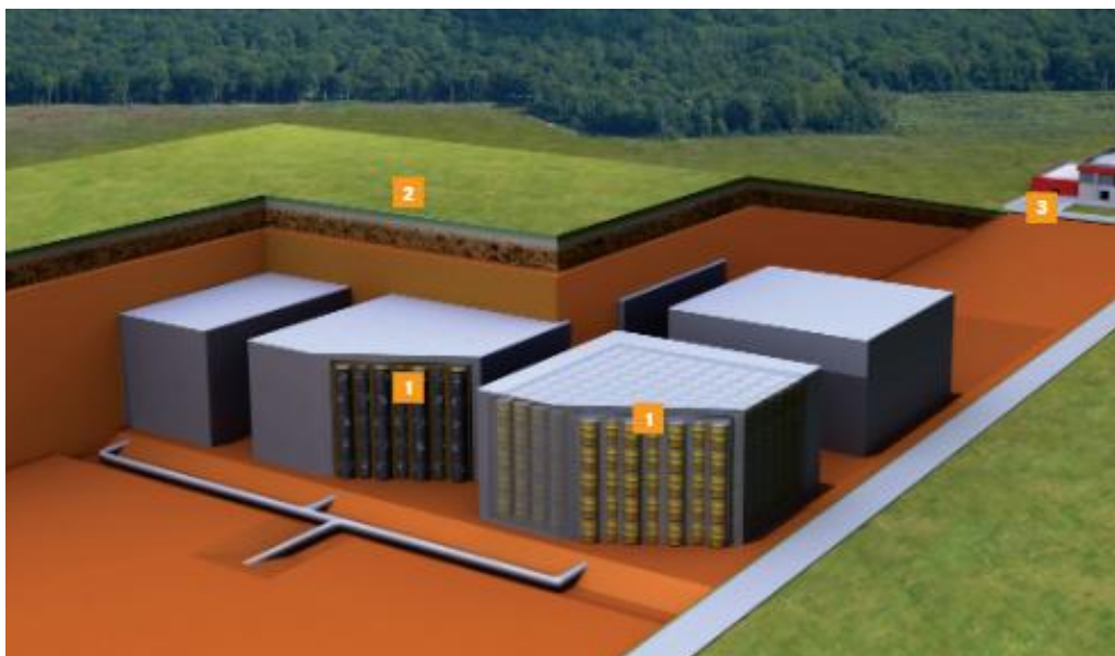
Obrázek 6: Schéma povrchového úložiště CSA v l'Aube, ANDRA 19
