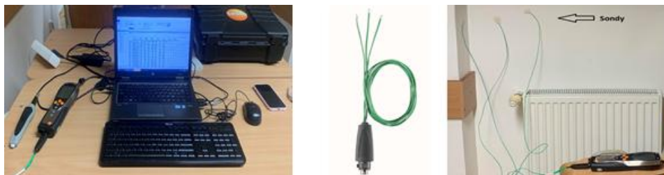
Obrázok 13: Merací prístroj Testo 635 s počítačom, meracia sonda a 3 meracie sondy pri meraní
