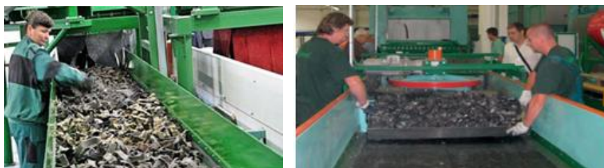
Obrázok 4: Textilný odpad po druhej operácii rezania a plnení foriem na lisovanie 6
