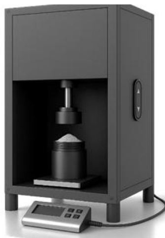
Obrázok 12: Zariadenie na merané plnenie testovacích kaziet sypkými materiálmi
