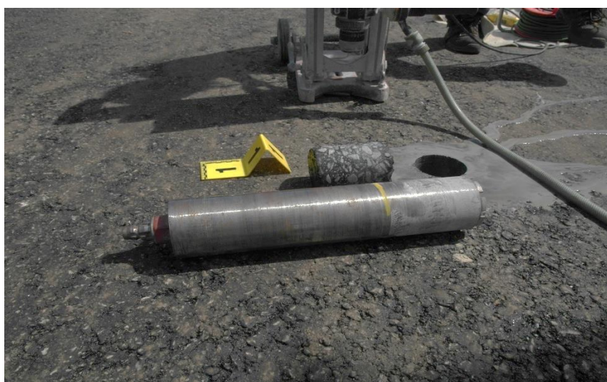
Obrázek 4: Odběr zkušebních těles metodou jádrových vývrtů s vodním výplachem
