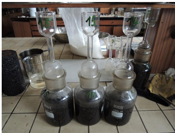
Obrázek 8: Pohled na laboratorní zkoušku stanovení maximální objemové hmotnosti asfaltové směsi v silniční laboratoři Fakulty stavební ČVUT v Praze
