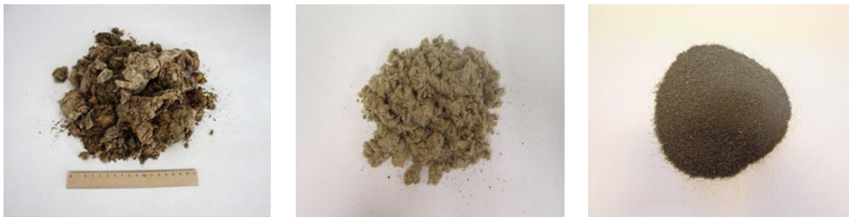
Obrázek 8: Úprava směsného odpadu minerální vlny (vlevo) na minerální vlákno a granálie
