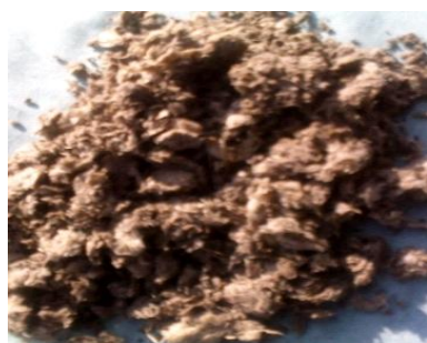
Obrázek 5: Odpad z výroby skelné minerální izolační vlny z pod rozvlákňovacího stroje
