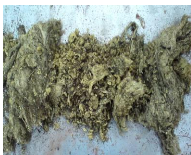
Obrázek 4: Odpad z výroby kamenné minerální izolační vlny z pod rozvlákňovacího stroje
