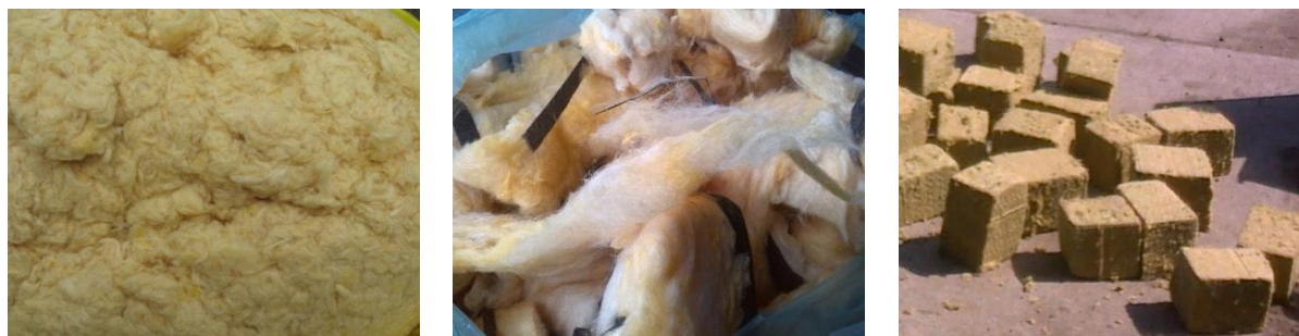
Obrázek 6: Příklad odpadu z výroby minerální izolační vlny vzniklé za vytvrzovací komorou
