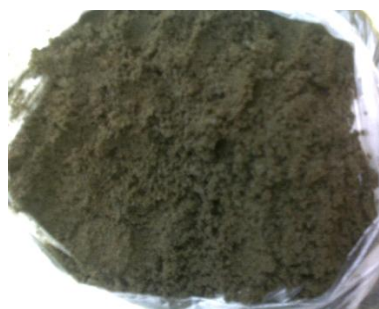
Obrázek 5: Odpad z výroby skelné minerální izolační vlny z pod rozvlákňovacího stroje
