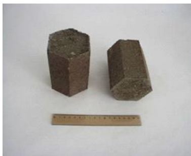
Obrázek 3: Zpětný produkt vracející se do tavicí lázně – brikety
