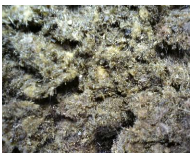
Obrázek 4: Odpad z výroby kamenné minerální izolační vlny z pod rozvlákňovacího stroje
