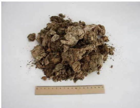
Obrázek 1: Znečištěné chomáče odpadní minerální vlny s granáliemi
