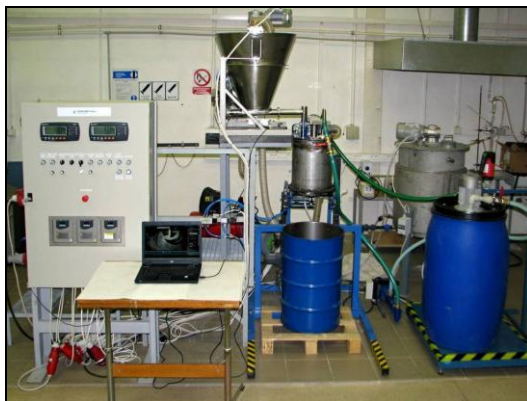
Obrázek 1: Jednotka pro solidifikaci kalových radioaktivních odpadů.
