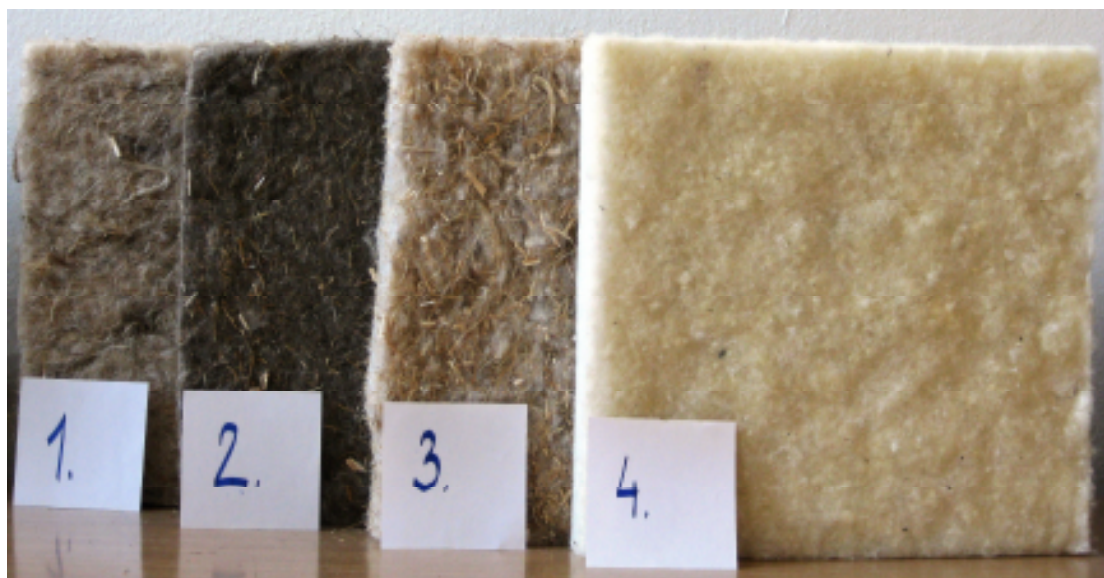
Obrázek 2: Ukázka testovaných zkušebních těles ve tvaru desky o rozměrech 300 x 300 mm
