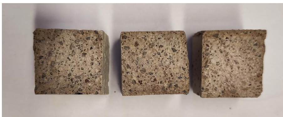
Obrázek 4: Vzhled lomových ploch trámečků z pojivové malty po fenolftaleinové zkoušce po 2 dnech v CO 2 komoře.
