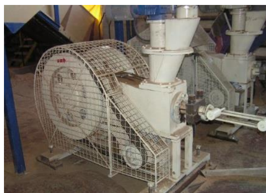
Obrázok 9: Princíp otvorenej lisovacej komory a mechanický kľukový BL 8
