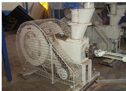
**Obrázok 9: Princíp otvorenej lisovacej komory a mechanický kľukový BL <sup>8</sup>**
