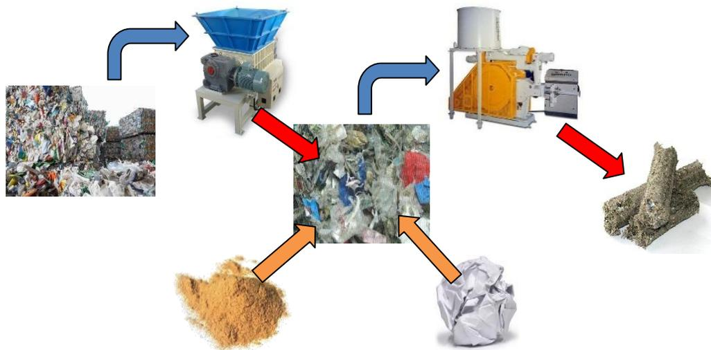
**Obrázok 7: Schematická ilustrácia spracovania komunálneho odpadu**
