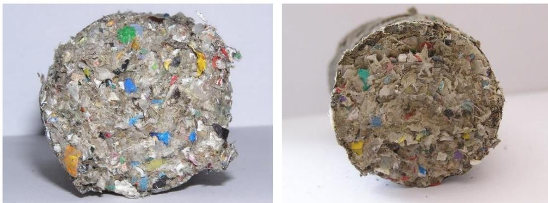
Obrázok 20: Vyrobené brikety, na mechanickom BL (vľavo) a na hydraulickom BL (vpravo) <sup>16</sup>
