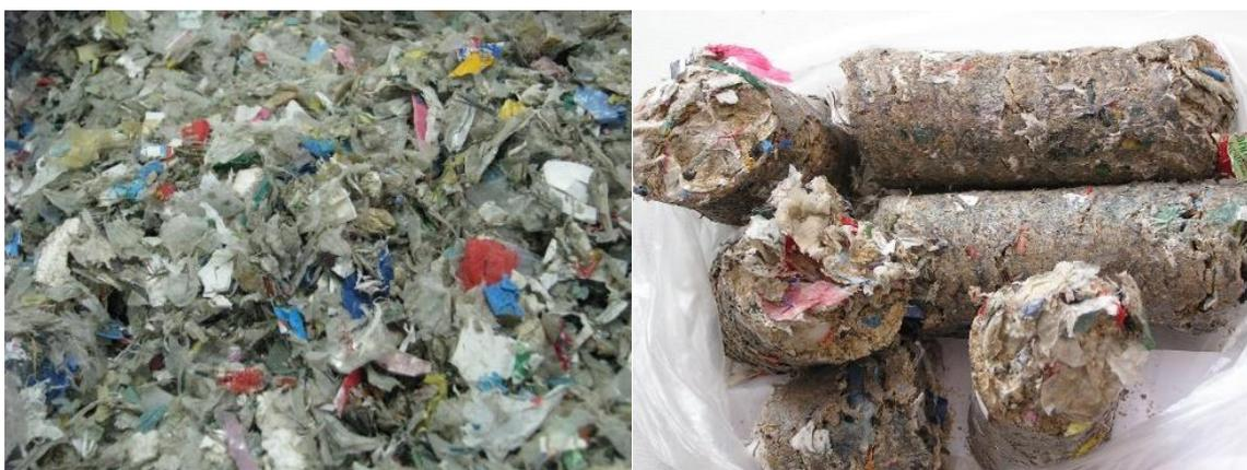
Obrázok 14: Dezintegrovaný komunálny odpad (vľavo) a žiadané produkty – brikety (vpravo) <sup>14,15</sup>
