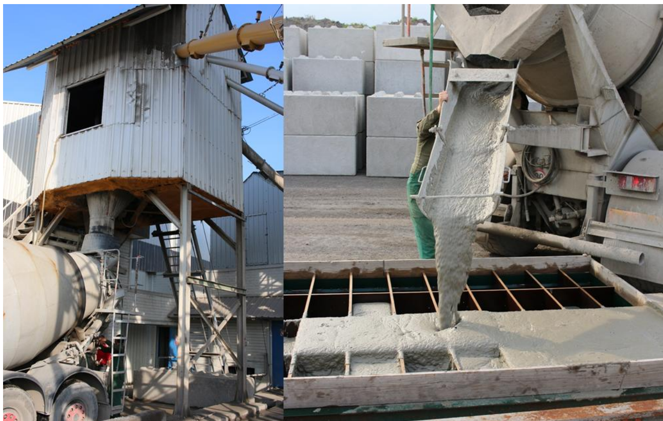
Obrázek 1: Proces nakládání čerstvé směsi do domíchávače (vlevo). Poloprovozní plnění forem (vpravo).
