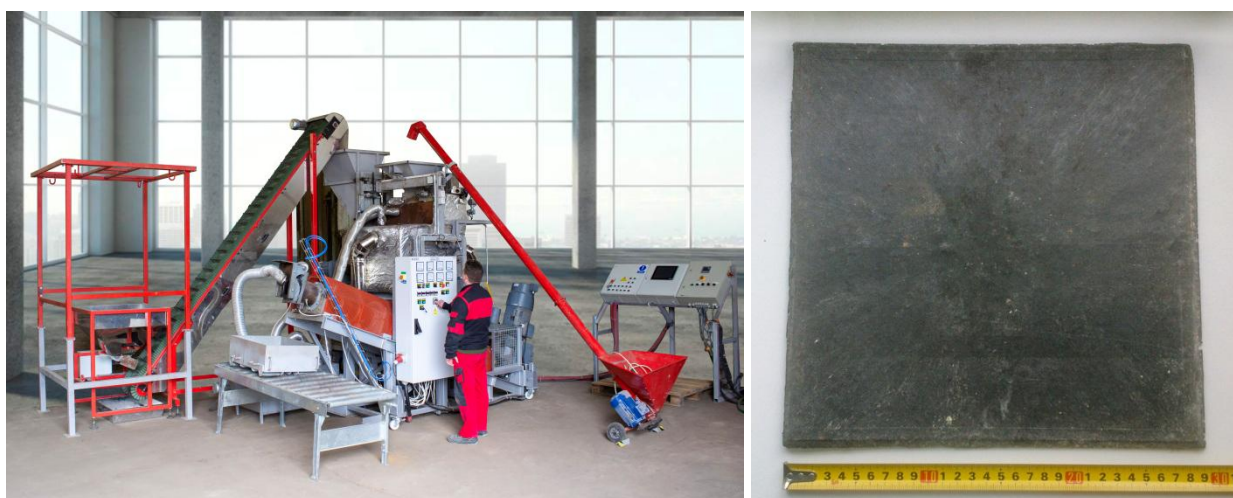
Obrázek 1: Technologická linka pro výrobu polymerbetonu (vlevo) a polymerbeton (vpravo) tvořený výmětem obsahujícím 50 hm. % písku
