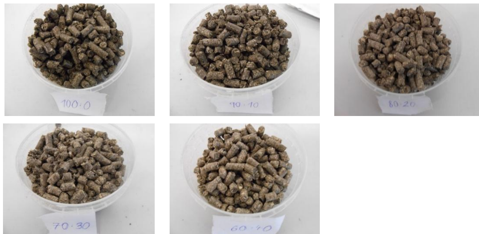
Obrázok 2: Pelety jednotlivých zmesí rôznych hmotnostných pomerov surovín - slnečnicové šupky : smrekové piliny
