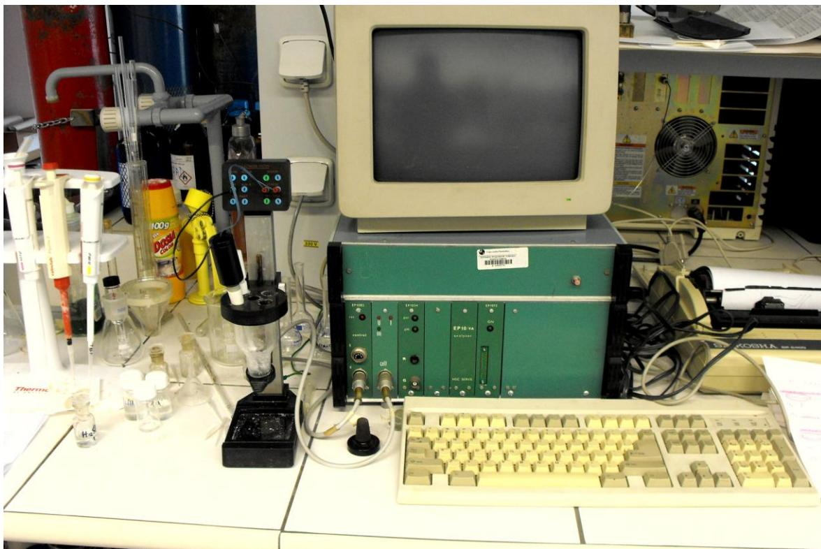
Obrázek 1: Použitý elektrochemický analyzátor EP 100
