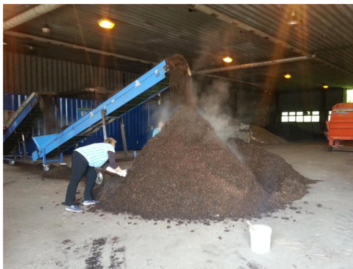
Obrázek 3: Vyskladňování fermentoru a odběr vzorku produktu
