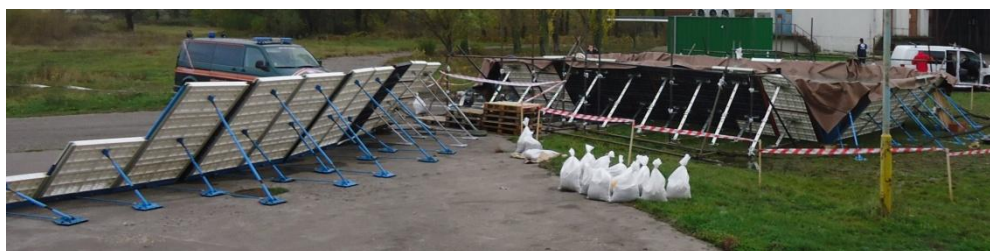
Obr. 12: Skúška v Gabčíkove, bazén 5x10 m a ukážková stena 12 m
