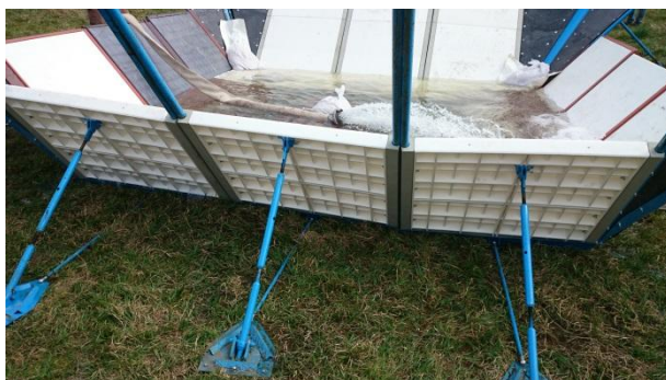
Obr. 14: Skúška tesnosti štruktúry pre vodu výšky 0,8m v Bratislave pri Malom Dunaji
