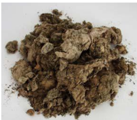
Obrázek 1: Znečištěné chomáče odpadní čedičové vlny
