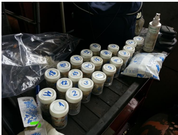
Obrázek 2: Ampule s kontrolními mikroorganismy pro kontrolu hygienizace
