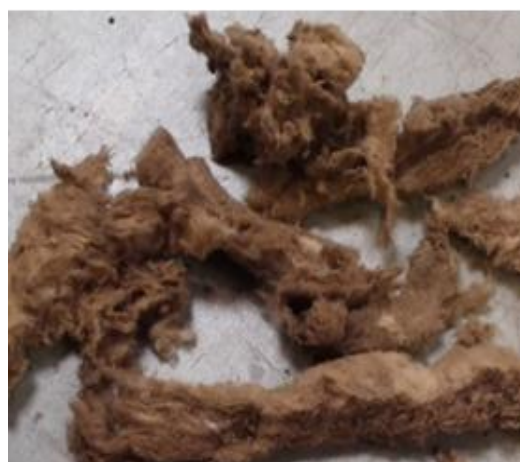
Obrázek 2: Znečištěné chomáče odpadní skelné vlny
