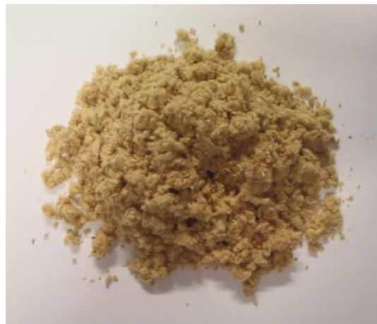
Obrázek 4: Upravená skelná vlna
