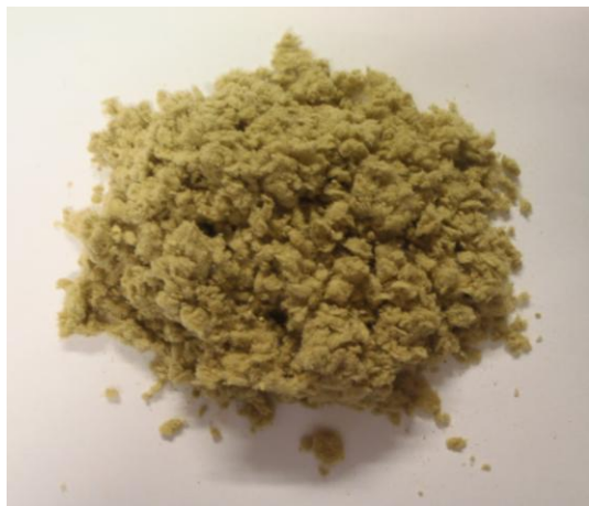
Obrázek 3: Přechištěná čedičová vlna
