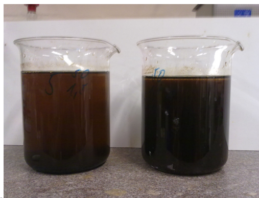
Obrázek 3 Efekt tvorby magnetitu; vlevo hodinu usazený vzorek, vpravo čerstvě odebraný
