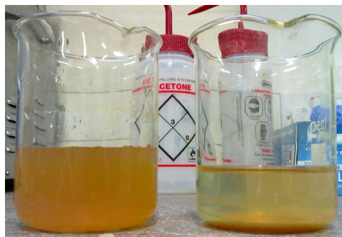
Obrázek 10: Porovnání čerstvého (vlevo) a 1 hodinu usazeného (vpravo) zásobního roztoku obsahující \text{Fe}^{3+} , \text{Mg}^{2+} a \text{Mn}^{2+} ionty
