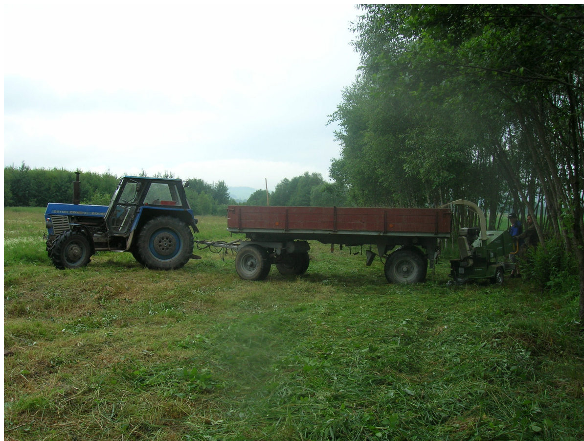
Obrázek 1: Štěpkování výřezu z údržby krajiny štěpkovačem Pezzolato PZ 110 M-b na přistavenou traktorovou soupravu
