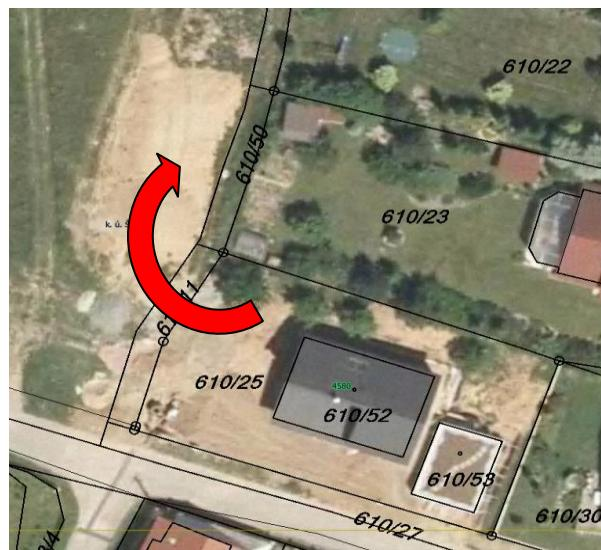
Obrázek 1: Příklad deponování výkopových hmot mimo stavební pozemek
