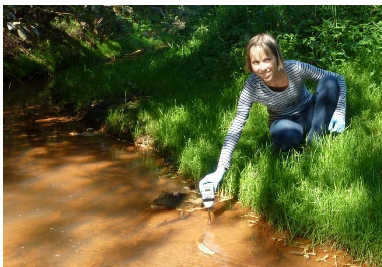
Obrázek 3: Využití EnviroPenu pro stanovení halogenovaných derivátů uhlovodíků na kontaminované lokalitě (Neratovice, Česká republika).
