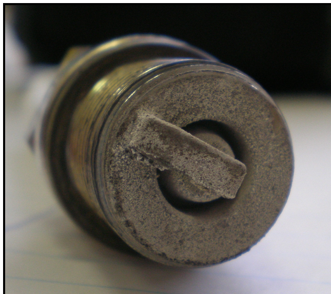
Obrázek 3: Oxid křemičitý usazený na zapalovací svíče.
