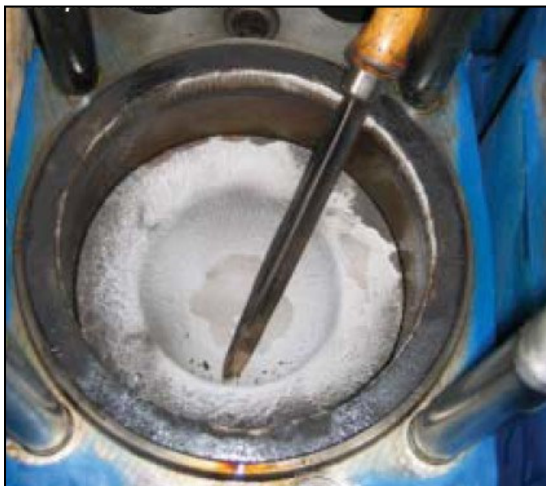
Obrázek 2: Usazování \text{SiO}_2 na povrchu pístu ve spalovacích prostorech motoru v podobě pevné krusty.
